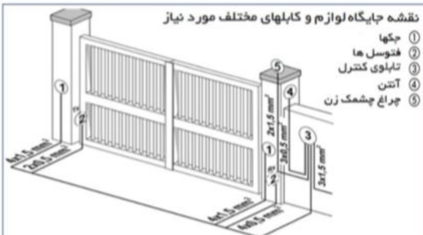
شکل ۶ : نقشه سیم کشی و سایز کابل‌های مورد نیاز
